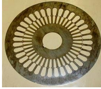
احدى رقائق العضو الساكن (الخارجية) والعضو الدوار الداخلية
